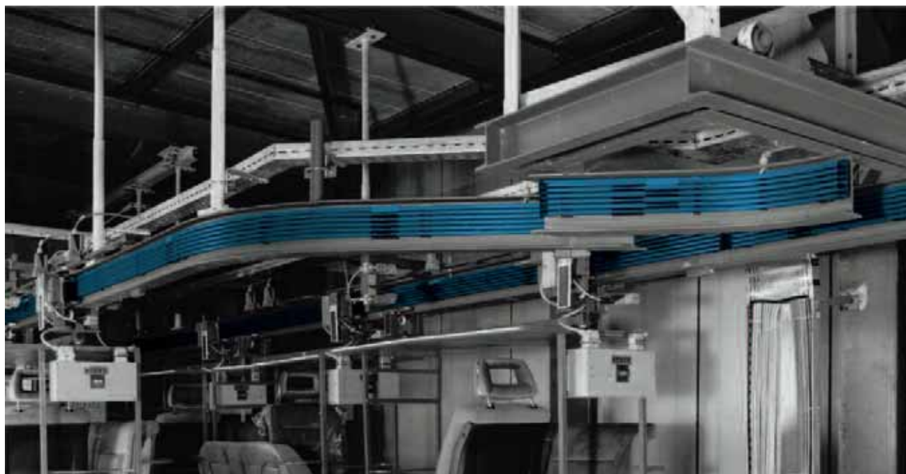
Carril unipolar aislado U 15, 6 polos, en una Electroavía con Cambios de vía en una fábrica de automóviles.
